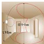
Зони на реакция при монтаж на стена
